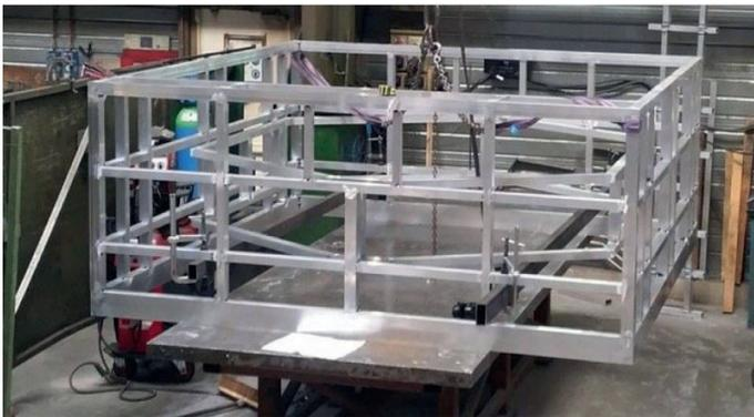
Figure 7 Structure de la caméra NectarCam
